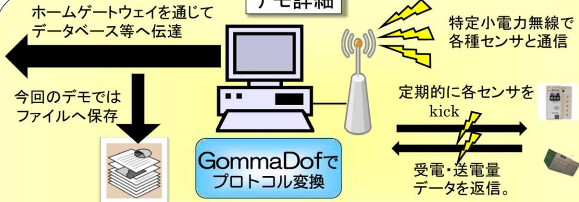
GommaDofを用いて各プロトコル・データ構造・ファイル(csv)間の変換を実装。GommaDofを用いてコマンドラインインターフェイスを半自動生成。
